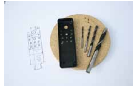
Gebohrt wird langsam und ohne Druck mit einem Holzbohrer. So schmilzt der Kunststoff nicht und man erhält eine Bohrung mit sauberem Rand.
