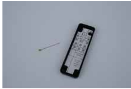
Sie passt ganz exakt ins Gehäuse. Zum Anreiben der Bohrzentren dient eine Stecknadel.
