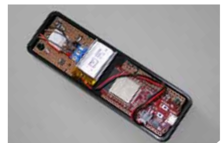
So liegt die Platine im Gehäuse. Man beachte den USB-Anschluss an der Unterkante, über den man den Handregeler-Akku laden kann.
