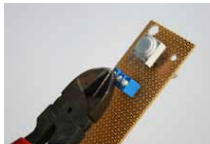
Beim Schalter werden die Lötösen abgekniffen, da sie zu tief ins Gehäuse ragen.
