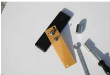
Auch die Lochrasterplatine wird passend gebohrt. Dann werden zuerst der Drehgeber und der Schalter montiert.
