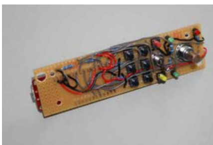
Alle Teile sind montiert und alle Verbindungen hergestellt. Hier die Bedienseite der Platine
