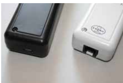
Für die USB-Buchse wird in der hinteren Gehäuseschale eine passende Aussparung gesägt und gefeilt, hier im direkten Vergleich zu einem FREMO-Loconet-Fredi.
