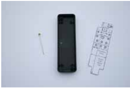
Die Bohrschablone wird ausgedruckt und ausgeschnitten.
