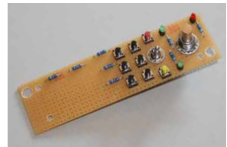
Die Bauteile sind bestückt. Jetzt beginnt die Verkabelung.
