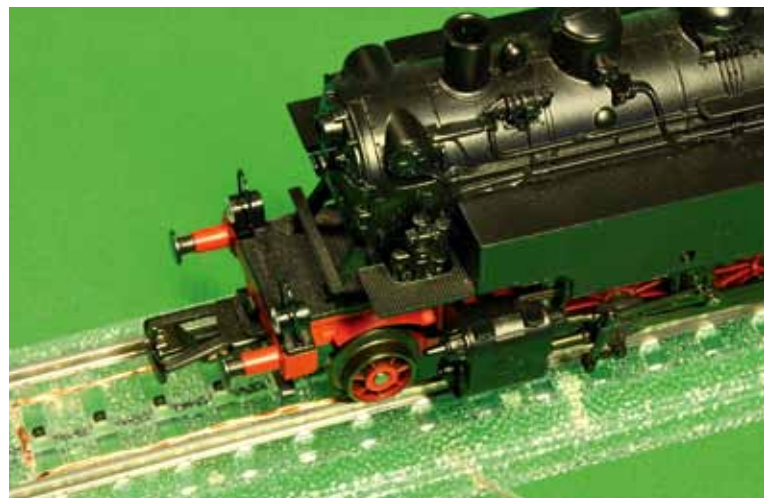
Eine „selbstgehäkelte“ Antenne für den NFC-Empfang auf 13,56 MHz in einem Märklin-H0-Gleis.
