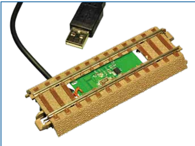
Der SCL3711[3] lässt sich mit ein wenig Geschick unter Zweileiter-H0-Gleisen unterbringen. Besonders einfach geht es bei Bettungsgleisen (hier: TRIX-C-Gleis). Der Durchbruch im Schwellenbereich wurde nur ausgeführt, um die Lage des Readers besser abbilden zu können.
